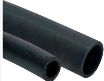
\* Chloropren Außendecke, Temperaturbereich: -30°C bis max. +130°C, Betriebsdruck: 4 bar, Platzdruck: 12 bar, nach DIN 73411/79
