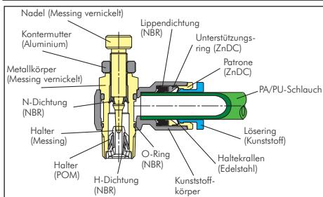
**Funktionsprinzip:** Drosselrückschlagventile drosseln den Durchfluss in einer Richtung, in der anderen Richtung ist der Durchfluss ungedrosselt. Standardform sind die Drosselrückschlagventile „abluftregelnd“. Sind diese in z.B. einen Zylinder eingeschraubt, ermöglichen diese einen gleichmäßigen Lauf ohne Slip-Stick-Effekt. Bei Zylindern mit kleinem Volumen (kleiner Durchmesser/geringer Hub), werden Drosselrückschlagventile in der Sonderform „zulufregelnd“ eingesetzt.
