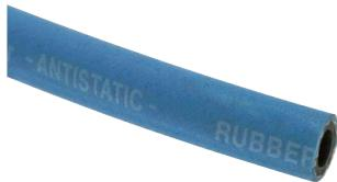
**Werkstoffe:** Innenseile: NBR/SBR schwarz, glatt, antistatisch, Außendecke: SBR/EPDM, glatt, abrieb-, witterungs- und ölbeständig, Gewebeeinlage: spiralierte, synthetische Textilfäden
